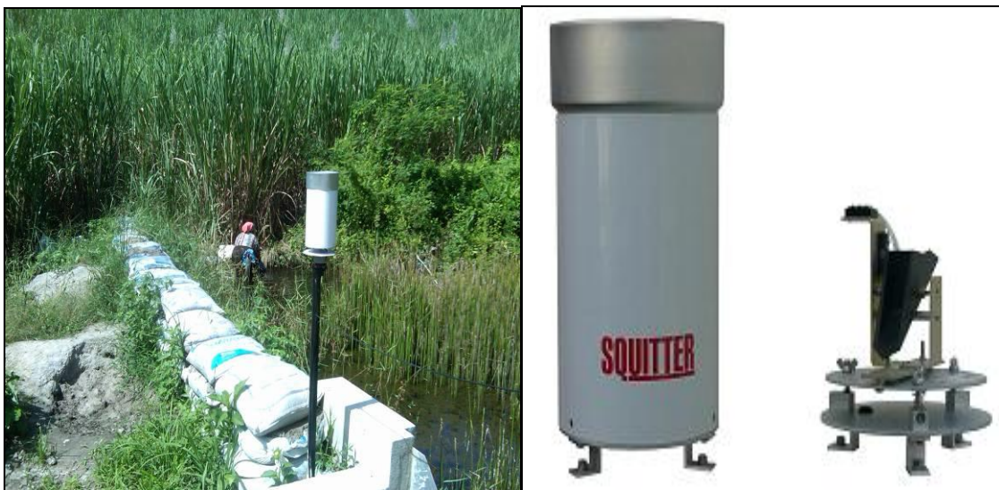
Figura 18 O Pluvimetro de bscula S2163 da Squitter feito em alumnio detm estrutura de equilbrio instvel responsvel pala quantificao da chuva atravs do preenchimento e variao do reservatrio interno de 0,25 mm
