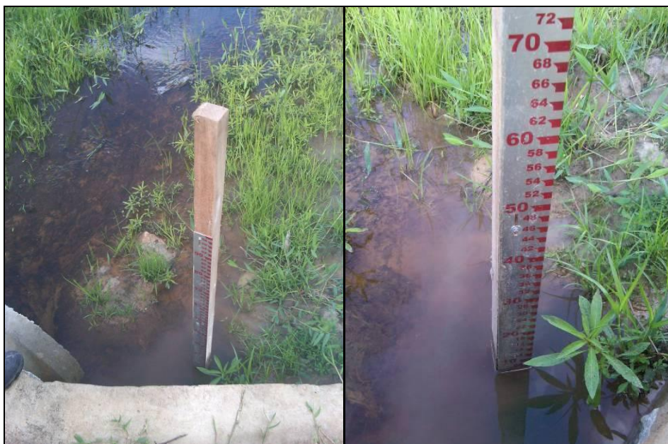
Figura 12 Régua limnimétrica da HIDROMECC com escala total de 1 metro e sub-divisões em centímetros.
