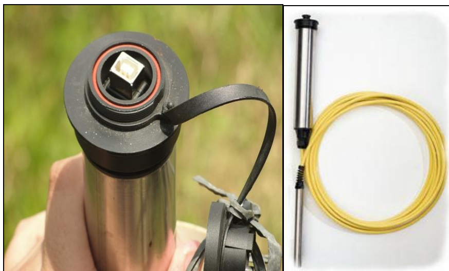
Figura 13 Aparelho de medição de nível automático WL16, com Data Logger acoplado de interface USB e sensor de pressão integrado.
