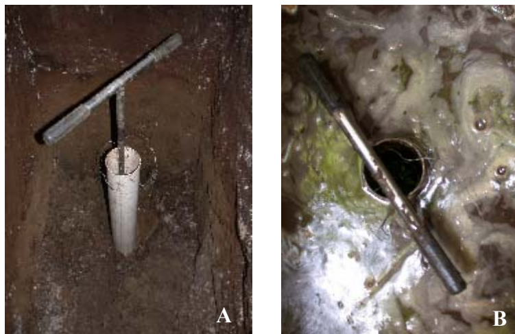
Figura 3.1.1. Esquema de amostragem em profundidade (A) trado revestido com tubo de PVC, (B) detalhe da tradagem com presença de lençol freático elevado
