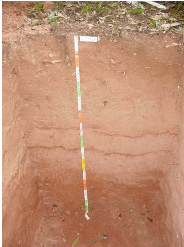
Figura 3.2.3. Trincheira 2. Argissolo vermelho-amarelo eutrófico abrupto arênico, instalada num trecho de Floresta Estacional Semidecidual do Projeto Parcelas Permanentes, na E.E. de Caetetus.
