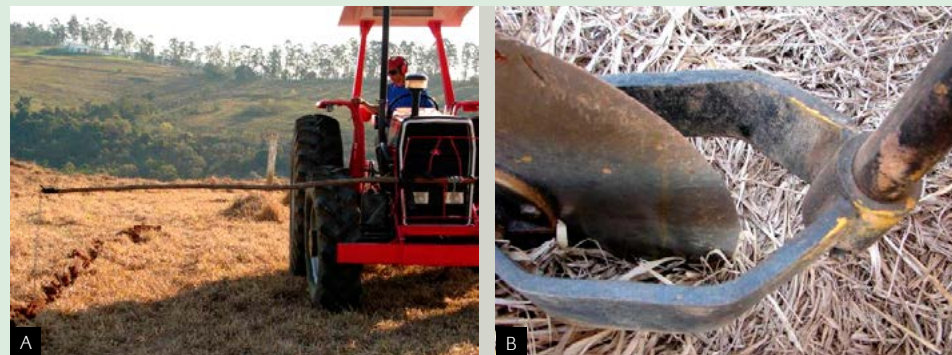
Figura 22: Uso de um pedaço de madeira com uma corrente em sua extremidade para a orientação da subsolagem em relação à linha adjacente (A) e disco de corte do subsolador cortando a palhada já seca (B).
