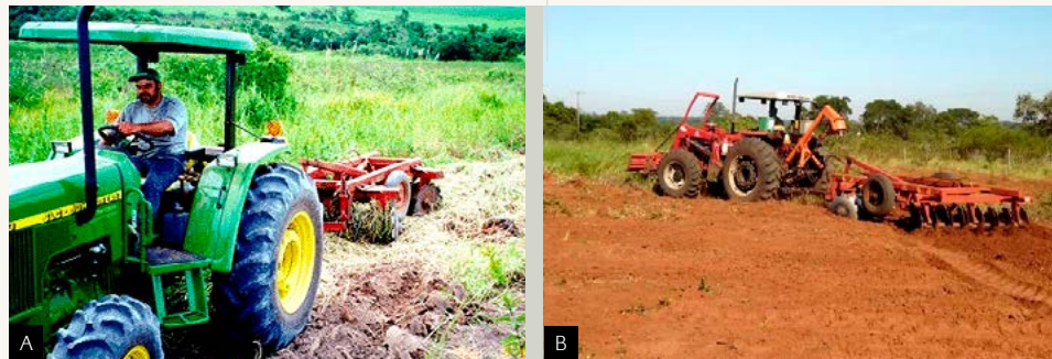
Figura 17: Incorporação de resíduos com gradagem leve (A) e pesada (B).
