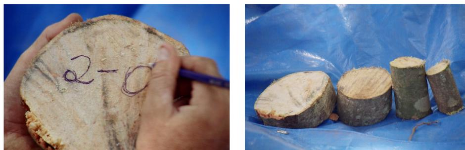
Figura 6: Identificação de cada amostra retirada do fuste, indicando árvore e posição da amostra nas árvores, e o acondicionamento final das amostras para determinação do teor de umidade.
